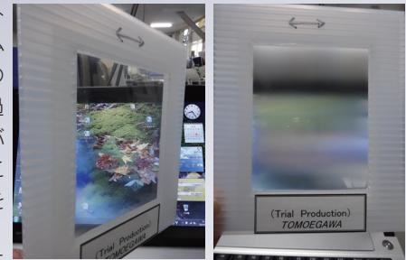
この機能を反射型LCDに応用すると、消費電力量を抑えつつ、「太陽光下での鮮明な表示」や「室内照明下での見やすい表示」が可能になるため、今後、普及が進むウェアラブル端末をはじめとして様々な市場での採用が期待されております。
