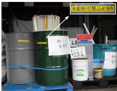
産業廃棄物の保管場所の看板にも種類欄に「水銀使用製品」を掲示
