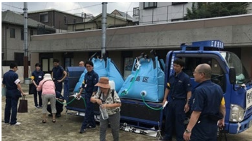
トラックに“フジコン”を積み給水車として使用 (三和紙工提供)
