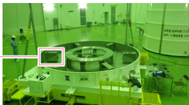
ドライエアーユニット JAXA 種子島実証テスト：ユニット設置時 衛星輸送用保護カバー 密閉時
