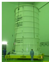
ドライエアーユニット JAXA 種子島実証テスト：ユニット設置時 衛星輸送用保護カバー 密閉時
