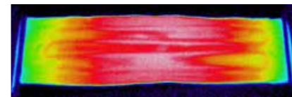
ニクロム線ヒーター + 熱拡散層 (アルミ箔)
