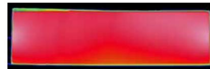
フレキシブル面状ヒーター + 熱拡散層 (アルミ箔)
