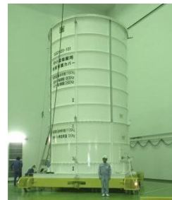
衛星輸送用保護カバー 密閉時
